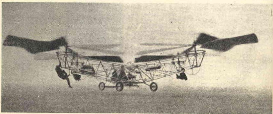
**Fig. 3.** - Il dominio dell'auto-giro fu incontrastato fino al 1939, anno in cui l'ingegnere SIKORSKY dimostrò agli increduli la validità delle sue asserzioni e la fondatezza dei suoi tentativi. Riuscì infatti ad innalzarsi da terra e restare sospeso in aria con uno strano telaio tubolare di sua progettazione, valendosi, per la sospensione e la traslazione, di due eliche orizzontali.
